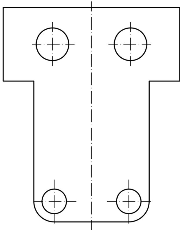
BLOQUE 1. EJERCICIO 4. - VISTAS. Dibuja a mano alzada las vistas (alzado, planta y perfil) de la pieza representada. El hueco de la pieza es pasante.
